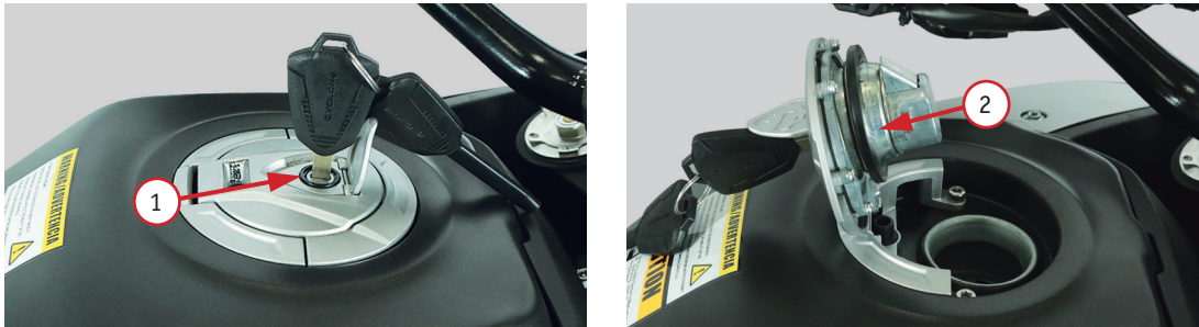
Фото 2.6. Топливный бак: 1 – замочная скважина на крышке; 2 – крышка бака открыта
