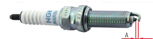
Фото 5.3. Зазор «А» между электродами свечи зажигания
