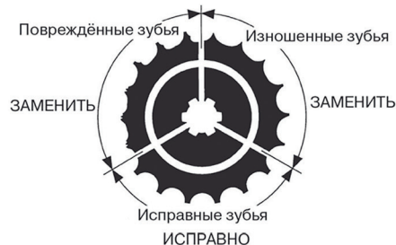
Рисунок 2. Износ звезд
