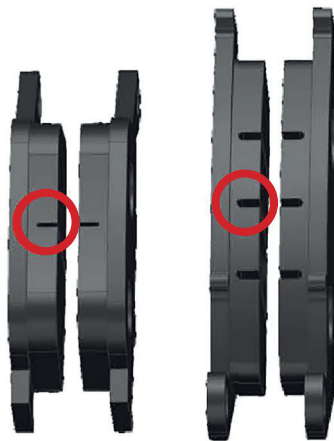
Фото 5.10. Определение износа тормозных колодок
