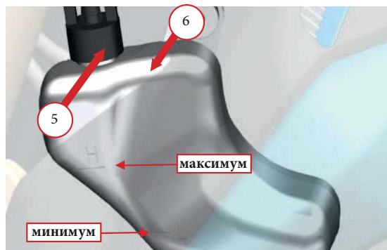
Фото 2.23. Доливание охлаждающей жидкости: 1 – крышка радиатора; 2 – заливная горловина; 3 – патрубков; 4 – радиатор; 5 – крышка расширительного бачка; 6 – расширительный бачок.
