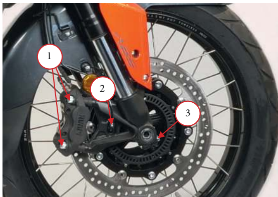
Фото 4.13. Снятие переднего колеса (вариант): 1 – болты тормозного суппорта; 2 – болт крепления датчика скорости; 3 – болт крепления оси.
