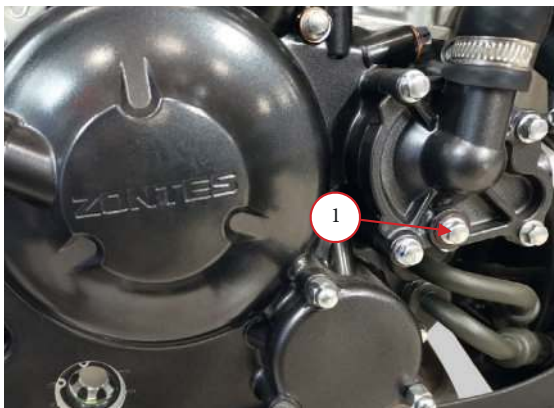
Фото 4.8. Слив охлаждающей жидкости: 1 – болт слива жидкости.
