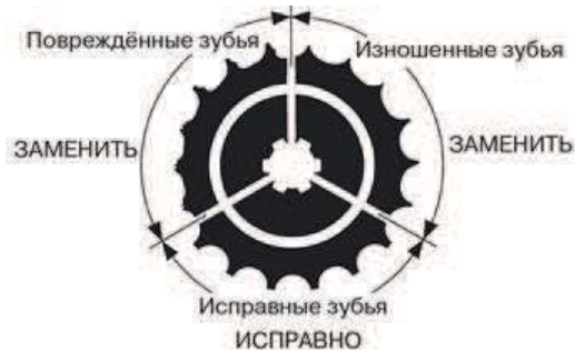
Рисунок 4. Износ звезд.
