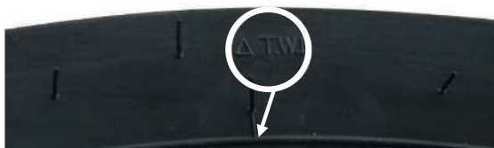
Фото 2.27. Расположение метки износа шины.
