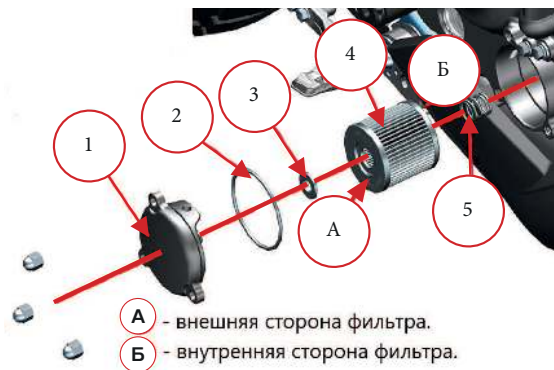
Фото 4.7. Замена масляного фильтра:
