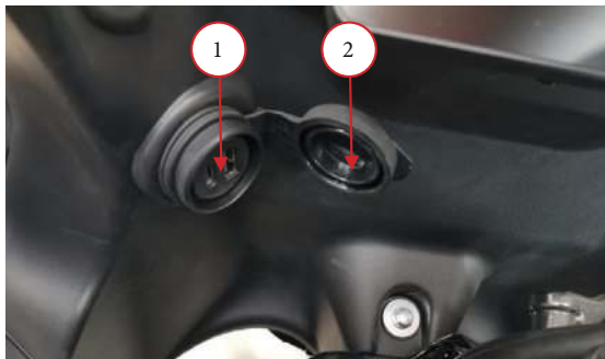
Фото 2.28. Разъем USB: 1 – разъем; 2 – защитная крышка.
