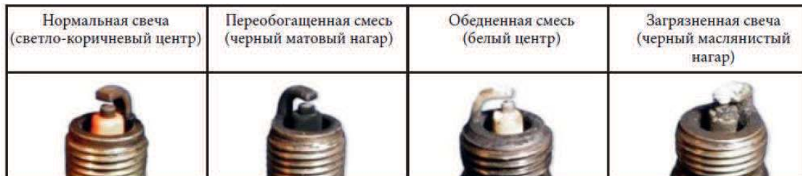
Фото 4.3. Состояния свечей зажигания.
