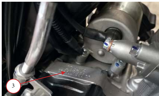
Фото 1.2. Справа на двигателе нанесен серийный номер двигателя - 3.
