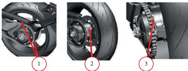
Фото 4.10.1. Регулировка цепи на консольном маятнике: 1 – болты крепления крыла; 2 – стяжной болт; 3 – эксцентриковый регулятор цепи.
