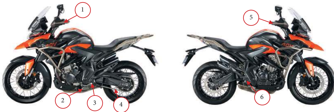
Фото 4.11. Элементы регулярной смазки: 1 – рычаг сцепления; 2 – боковая подножка с пружиной; 3 – ось рычага переключения передач и левая подножка водителя; 4 – цепь привода; 5 – рычаг тормоза; 6 – правая подножка водителя.
