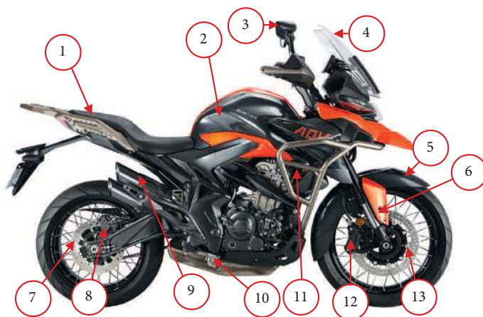
Фото 2.2. Вид справа: 1 – сиденье; 2 – топливный бак; 3 – зеркало заднего вида; 4 – ветровое стекло; 5 – крыло переднего колеса; 6 – защита правого педала; 7 – задний тормозной диск; 8 – задний тормозной суппорт; 9 – глушитель; 10 – педаль заднего тормоза; 11 – катушка зажигания; 12 – передний тормозной суппорт; 13 – передний тормозной диск.
