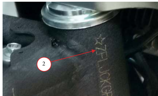
Фото 1.1. Бирка с серийным номером и годом выпуска – 1, расположена на нижней части рамы. Надпись с VIN номером - 2 нанесена на рулевом стакане.
