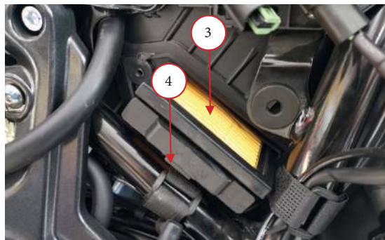
Фото 4.1. Снятие воздушного фильтра: 1 – винт крепления крышки; 2 – крышка фильтра; 3 – воздушный фильтр; 4 – скобка корпуса фильтра.
