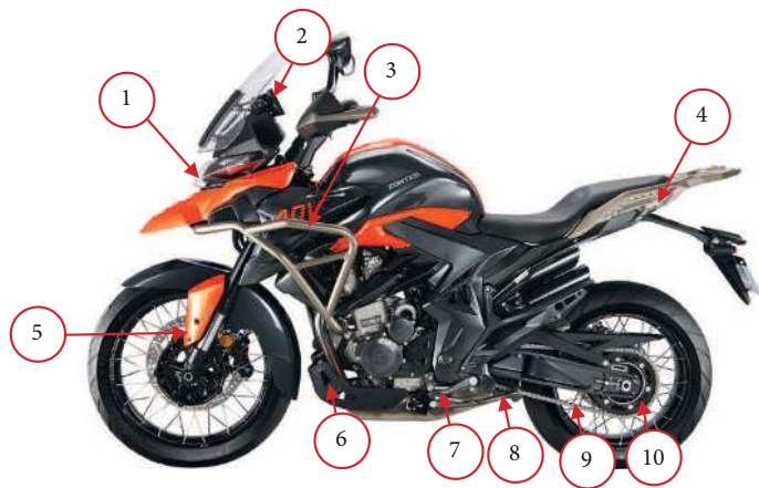
Фото 2.3. Вид слева: 1 – передняя фара; 2 – приборная панель; 3 – элементы защиты; 4 – заднее крыло; 5 – защита левого пера; 6 – защита картера; 7 – рычаг переключения передач; 8 – боковая подножка; 9 – приводная цепь; 10 – ведомая звезда.
