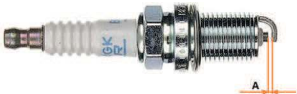
Фото 4.4. Зазор между электродами свечи зажигания.
