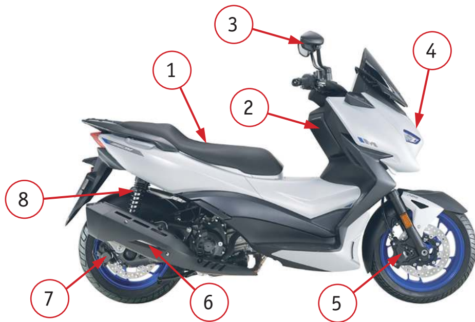
Фото 2.2. Вид справа: 1 – сиденье; 2 – правый ящик; 3 – зеркало заднего вида (две штуки); 4 – передняя фара; 5 – передний тормозной суппорт; 6 – глушитель; 7 – задний тормозной суппорт; 8 – задний амортизатор (две штуки).
