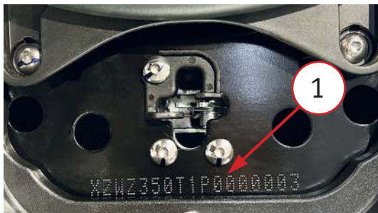
Фото 1.1. Надпись идентификационного номера 1 расположена под сиденьем. Табличка с VIN номером, датой выпуска и номерами 2 расположена в передней части скутера над радиатором.
