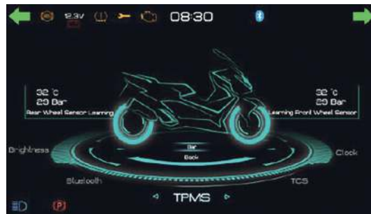
Фото 2.12. Панель контроля давления.
