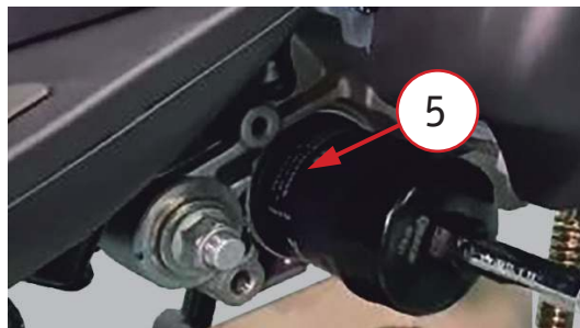
Фото 4.6. Замена масляного фильтра: 1 – болт; 2 – шайба; 3 – защита фильтра (не у всех моделей); 4 – гайка; 5 – масляный фильтр.
