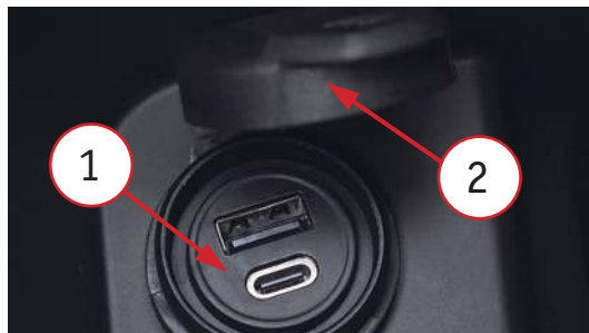
Фото 2.22. Разъемы: 1 – место размещения разъемов; 2 – защитная крышка.
