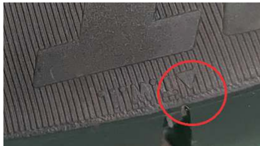
Фото 2.21. Расположение метки износа шины.
