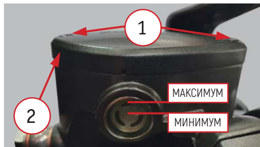
Фото 4.9. Бачок тормозной жидкости передних и задних тормозов:
