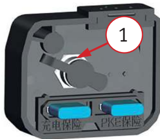
Фото 4.1 Место подключения зарядки АКБ: 1 – розетка для зарядки.
