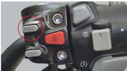
Фото 2.16. Открывание крышки топливного бака (с бесключевым доступом): «FUEL» - кнопка открытия внешней откидной крышки; 1 – внешняя защитная крышка; 2 – крышка топливного бака.
