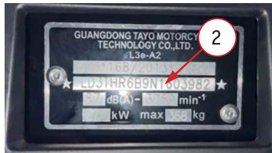
Фото 1.1. Надпись идентификационного номера 1 расположена под сиденьем. Табличка с VIN номером, датой выпуска и номерами 2 расположена в передней части скутера над радиатором.
